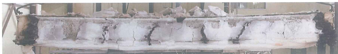
照片 2 耐火性能试验结束时试件情况
