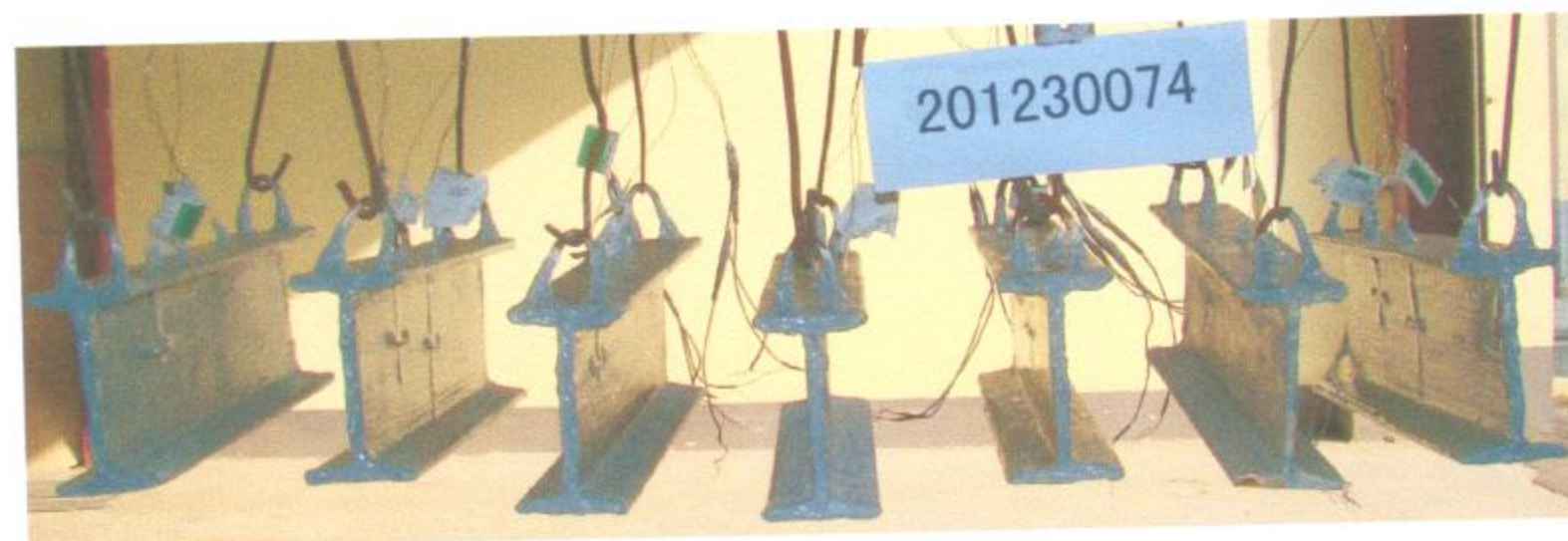
照片 2 附加耐火试验前小钢梁试件情况
