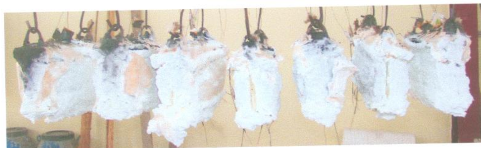
照片 4 附加耐火试验结束时小钢梁试件情况
